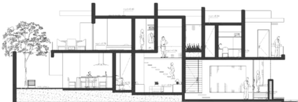
Figura 4. Vista en corte con sistemas de piso a distinto nivel (Sánchez, 2016).
