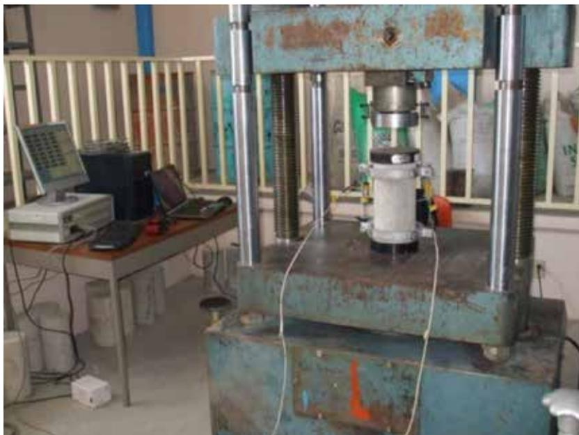
Figura 5. Ensaye de cilindros en prensa universal para la determinación del módulo de elasticidad.
