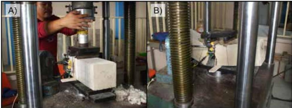
Figura 7. Ensayo de una viga de concreto  $f'c = 200 \text{ kg/cm}^2$  a veintiocho días, con diferentes proporciones de fibra. A) Colocación de los sensores para evaluar el espécimen; B) Falla del espécimen después de aplicar las cargas.
