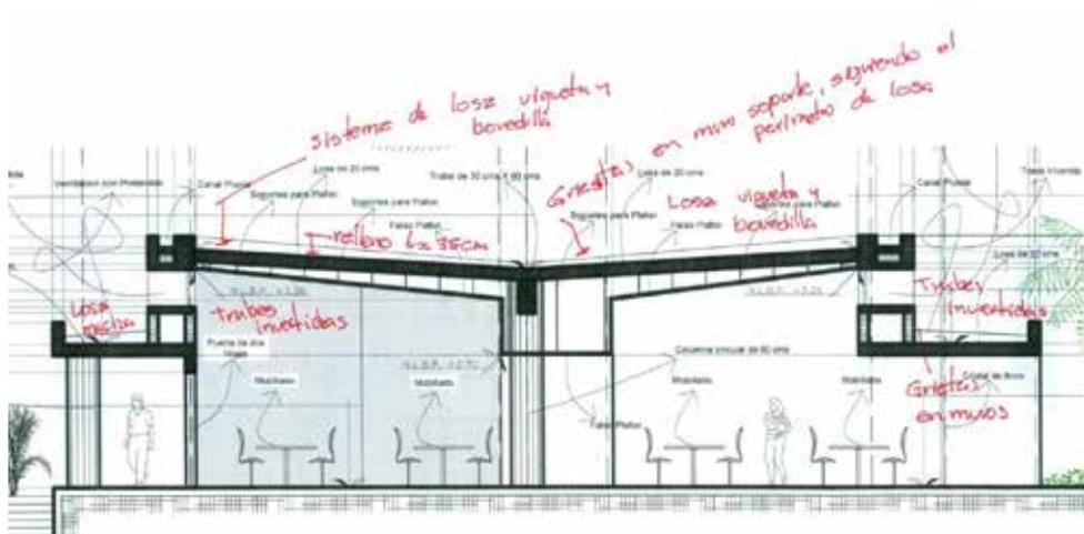
Figura 7. Corte con diferentes niveles de losa y material de relleno en azotea (Sánchez, 2019a).
