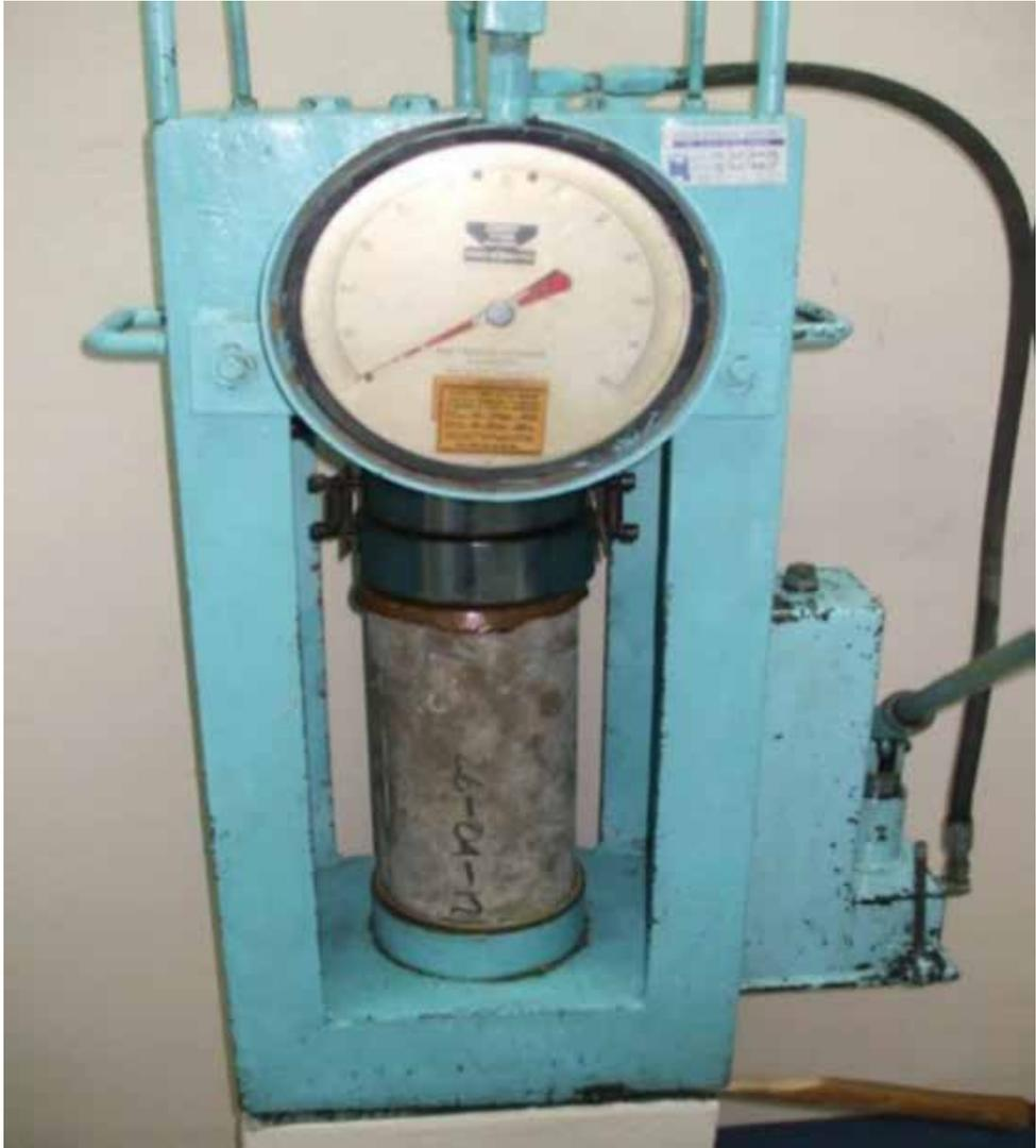
Figura 4. Ensayo de cilindros en prensa manual para la determinación de la resistencia a la compresión.
