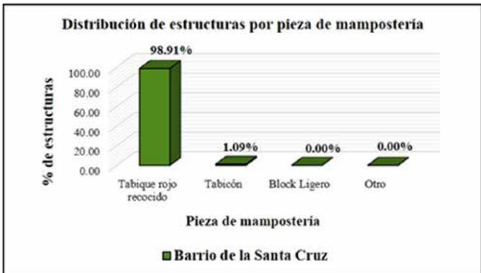
Figura 12. Distribución de estructuras por pieza de mampostería.
